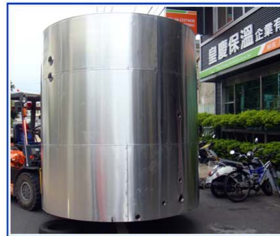
熱水桶隔熱保溫外覆鋁皮板金
